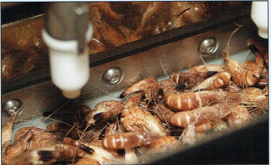
Opname in de machine van de te pellen garnalen
